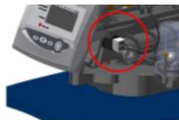
Elettrodo disinfezione montato
